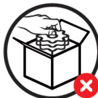
Les pièces à emballer doivent absolument être manipulées avec des gants propres car les traces de transpiration peuvent créer de la corrosion sur la surface du métal.
