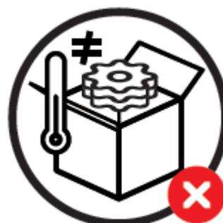
Les pièces à emballer doivent être à la température ambiante (donc ni trop chaudes, ni trop froides) pour éviter la formation de condensation. L'utilisation de sachets déshydratants est conseillée à l'intérieur de l'emballage pour parer à tous problèmes de condensation durant le transport.
